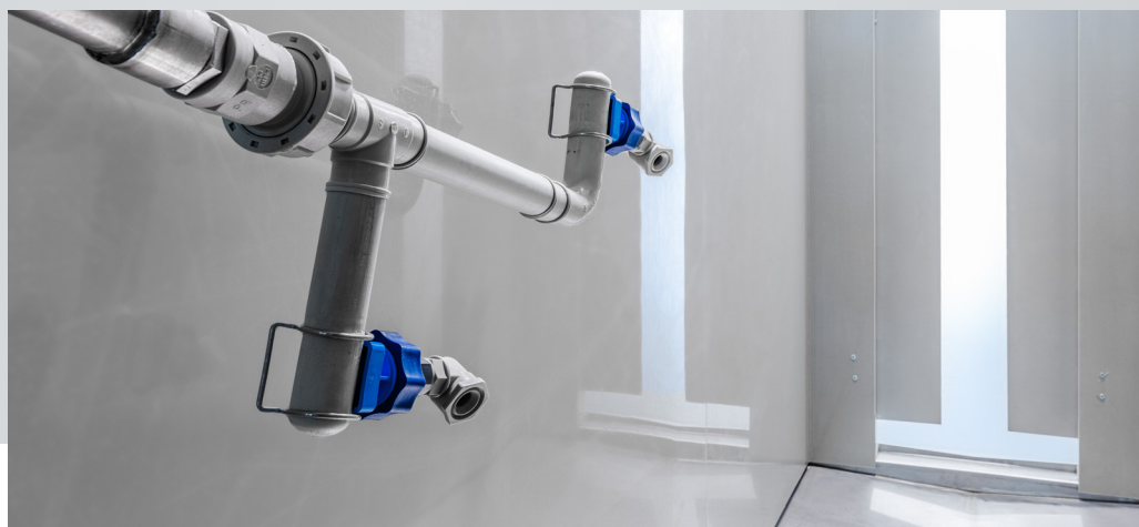
Dettaglio del braccio intercambiabile in polipropilene con ugelli di verniciatura orientabili Detail of the interchangeable polypropylene arm with swivelling paint nozzles
