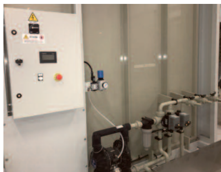
Particolare della vasca di ricircolo del prodotto inferiore, dotato di filtro metallico, modello SPRING.
