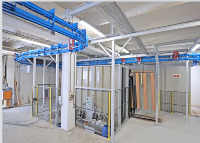
Sistemi di trasporto aereo per macchine di rivestimento a flusso (flow-coating) Overhead conveying systems for flow-coating machines
