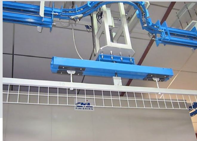
Sistemi di sollevamento e abbassamento per bilancelle porta pezzi Lifting and lowering systems for workpiece racks
