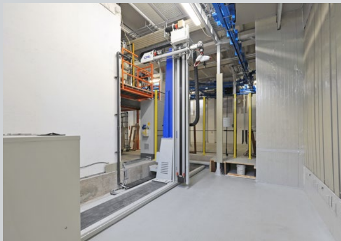
Sistemi di trasporto aereo per robot di verniciatura Overhead conveying systems for painting robots
